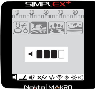
Drücken Sie die Einstellungs-Taste, um auf alle Einstellungen zuzugreifen. Wenn Sie die Einstell Taste drücken, wird die Lautstärkeeinstellung, die die erste Einstellung in der Einstellungsleiste am unteren Bildschirmrand ist, schwarz hinterlegt. Jedes Mal, wenn Sie die Einstell Taste drücken, wird die nächste Einstellung auf der Leiste ausgewählt und ihr jeweiliger Wert wird auf dem Bildschirm angezeigt. Sie können den Wert mit den Tasten plus (+) und minus (-) ändern.
