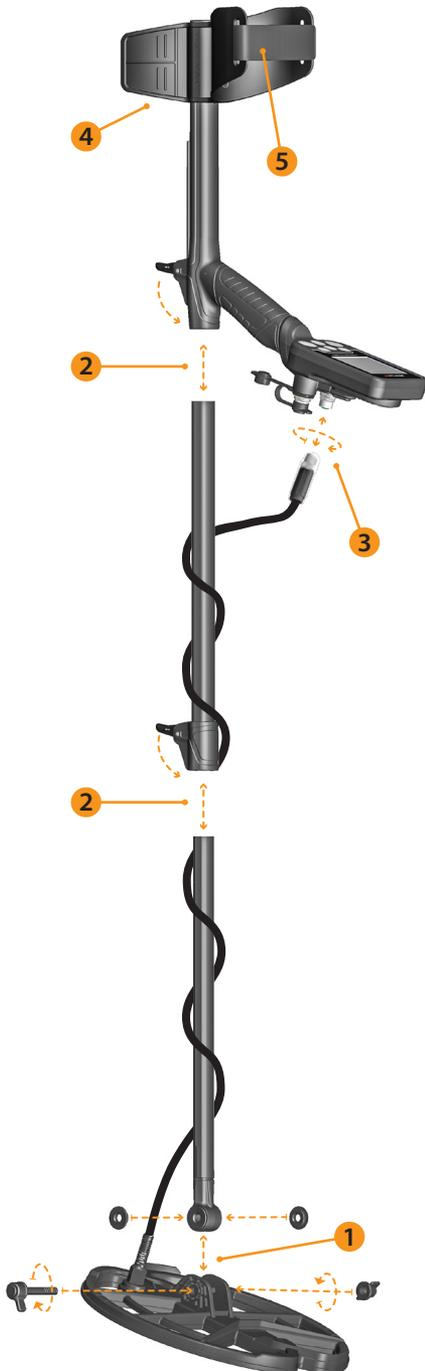
(1) Nach dem Einsetzen der Unterlegscheiben auf das untere Gestänge wird das untere Gestänge an seiner Stelle auf der Suchspule platziert. Sichern Sie diese durch Anziehen von Schraube und Mutter. Nicht überdrehen.
