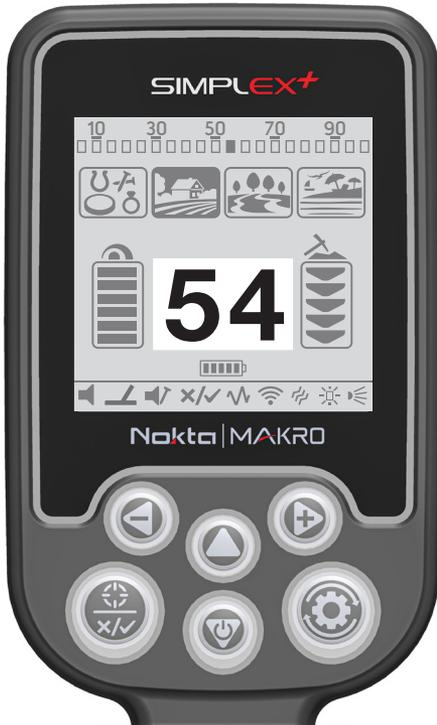
Die OBJEKT-ID ist die Zahl, die der Metalldetektor aufgrund der Leitfähigkeit der Metalle erzeugt und gibt dem Benutzer eine Vorstellung davon, worin das Objekt bestehen könnte. Die Objekt-ID wird zweistellig auf dem Display angezeigt und liegt zwischen 00-99.
