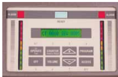
▲ Oben sehen Sie die Steuereinheit des MT5500 und die Anzeige für Alarm sowie Touchpad Einstellungen
